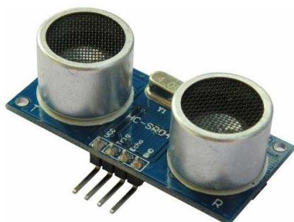
Ultrazvukový dálkoměr (sonar) je jedním z nejpoužívanějších senzorů, protože je levný, poměrně přesný a k micro:bitu celkem snadno připojitelný.
